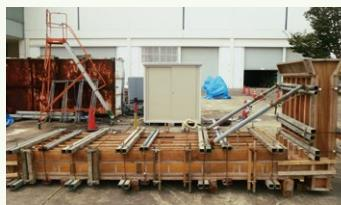
C-II断面の凹凸を3スパン分模擬した型枠でコンクリートを充填しました。テープを使った場合は空洞が発生しなかったのに対し、使っていない場合の平均充填率\*は89%で11%の空洞が発生、テープによる充填促進効果が確認されました。
